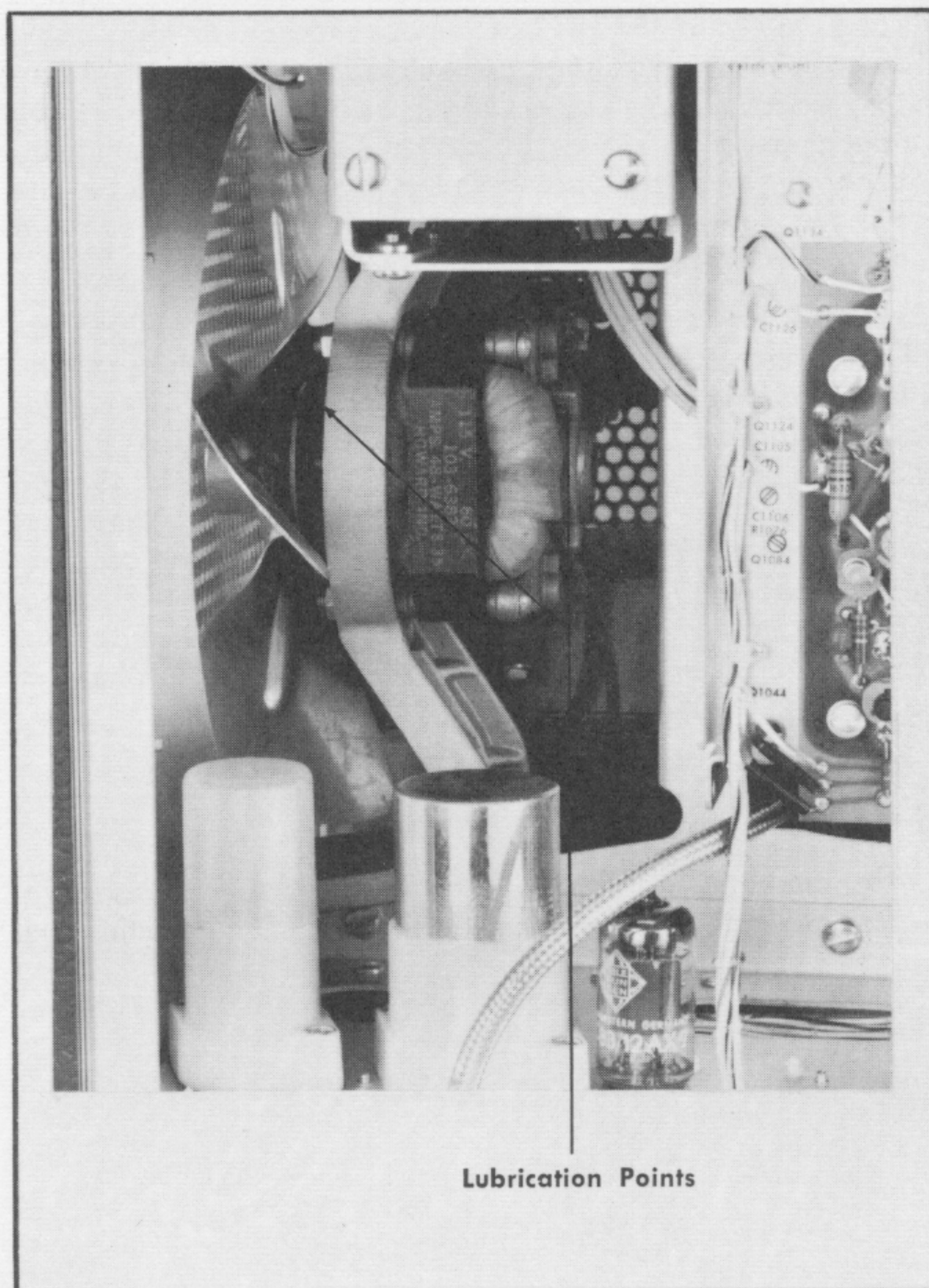
Fig. 4-1. Fan motor lubrication points.
